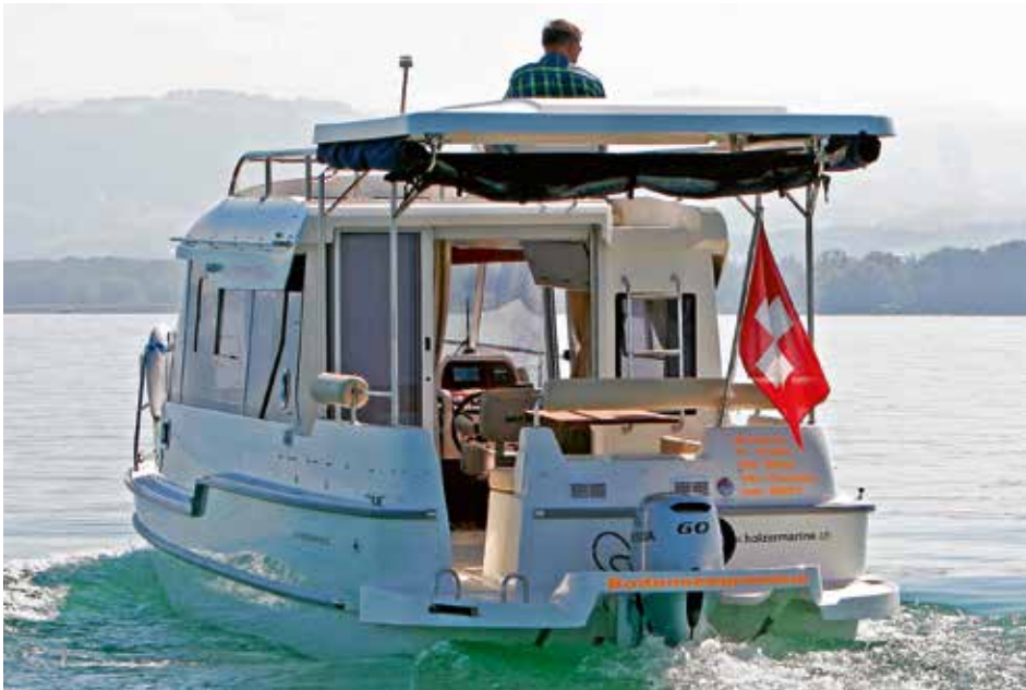
Außenborder achtern, in die Badeplattform integriert. Das feste Dach lässt sich verschieben.
